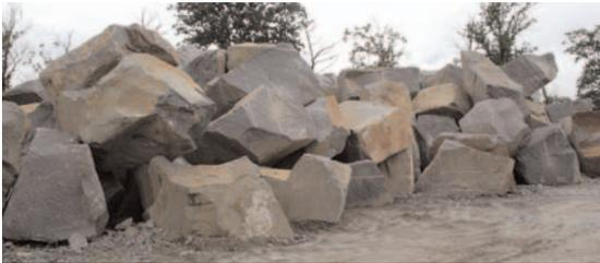
▲ L'activité enrochement et concassage devient de plus en plus importante pour la Socal. Les blocs d'enrochement varient entre 4-7 tonnes, 8-10 t. et 10-15 t. Trois granulométries de concassés sont réalisées : (0-20, 0-80 et 20-40). Le passage des morceaux au brise roche évite le mélange du granit avec de la terre.
