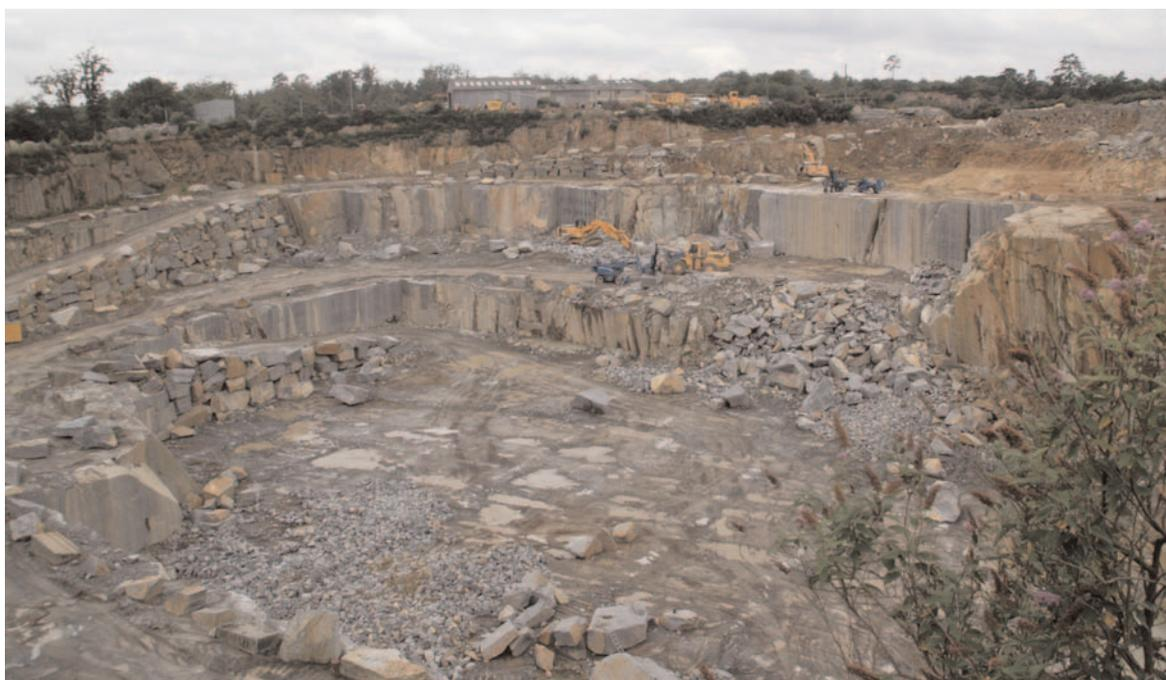
▲ Sur cette double page le site d'extraction du granite de Lanhélin moyen, ancienne carrière de Centre Avenir. Des masses primaires d'environ 3 000 m<sup>3</sup> sont dégagées par minage, avant la recoupe classique des blocs. Les perforations verticales et horizontales d'une dizaine de mètres chacune, sont réalisées à la vitesse de 50 m à l'heure. En vertical, la vitesse peut aller jusqu'à 1,80 m/mn. D'énormes blocs de 45 tonnes sont ensuite remontés par les chargeurs.
